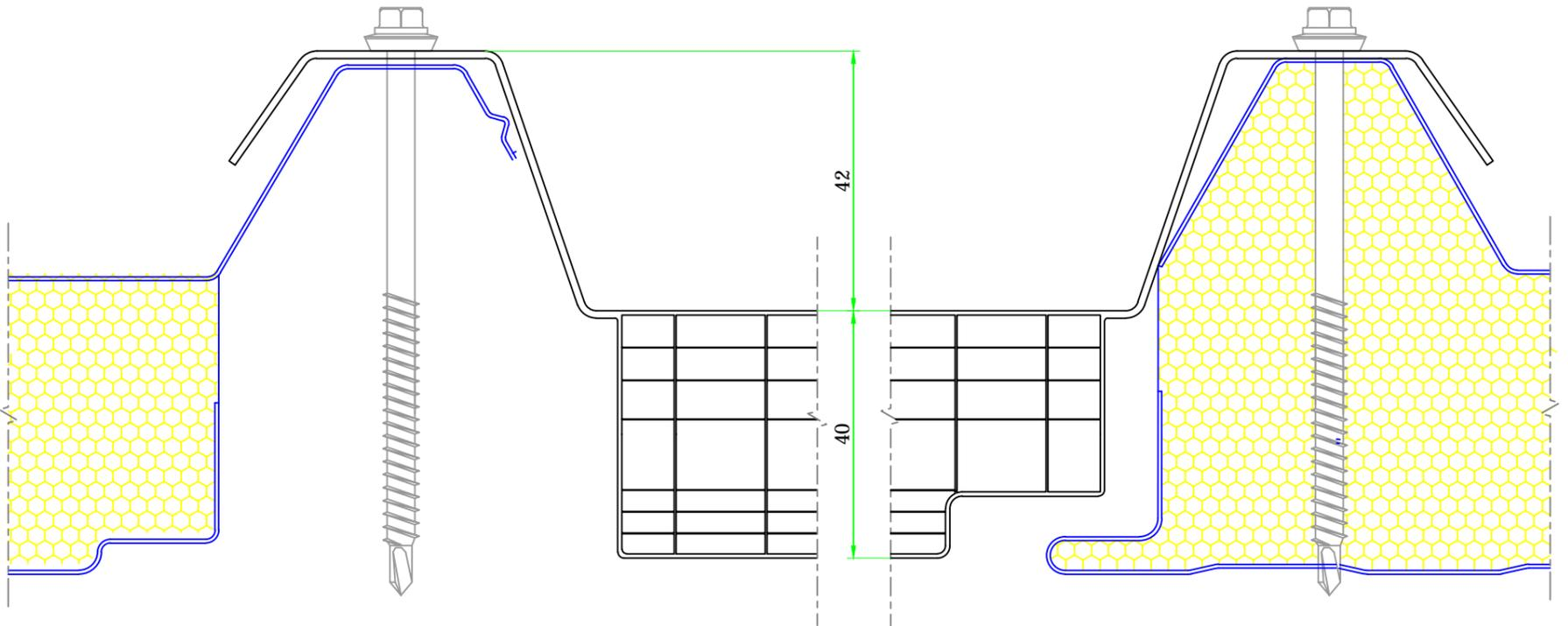
DETALLE DE ENCAJE CON PANEL DE POLIURETANO DE 40mm
