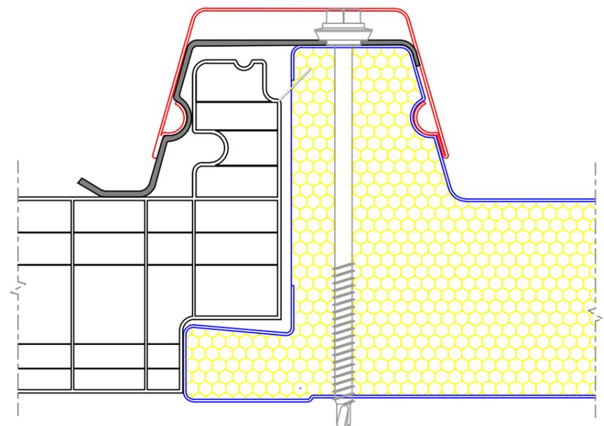
DETALLE DE ENCAJE CON PANEL DE POLIURETANO DE 40mm
